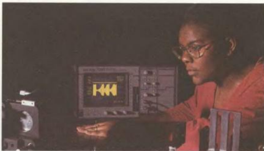
ЗЕЛДА ГИЛЛС, студент-дипломник Технологического института штата Джорджия, следит за интенсивностью излучения лазера, которая отображается на экране осциллографа в виде хаотических «вспышек». (Фото: М. Баррет, Технологический институт штата Джорджия.)
